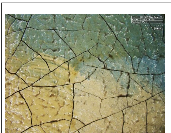
Slika 7 Fotografija roba sonde posneta z elektronskim mikroskopom Hirox (Foto: Ibrahim Elrefaey, UL FKKT)
